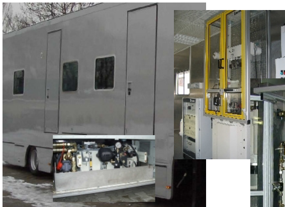
Установка в грузовик для испытаний вблизи гоночных трексов и испытательных полигонов
