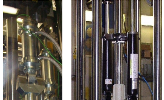
Испытание нескольких амортизаторов с оснасткой для бокового нагружения, измерение температуры и охлаждение воздухом/водой
