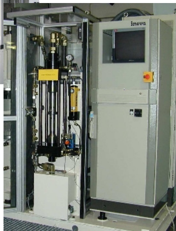
Гидравлический стенд для испытаний клапанов амортизаторов
