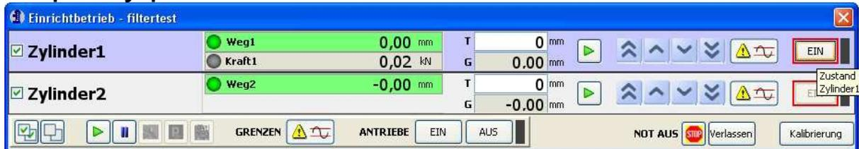
Окно настройки управления позволяет установить Ваши приводы в исходное положение, переключить и настроить приводы, активировать или сделать неактивными пределы. Контроль настроек позволяет управлять различными состояниями группы цилиндров вашего испытательного стенда, например, парковка, установка образца или состояние проведения испытания. Вы можете быстро идентифицировать статус всех Ваших приводов.
