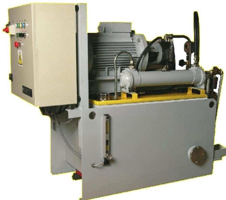
Гидравлические насосные станции серии НУ обеспечивают гидравлической энергией высокоточные сервогидравлические испытательные установки. Генерация давления осуществляется радиальным поршневым насосом с контролируемым давлением и автоматическим обеспечением потока в соответствии с реальными требованиями.
